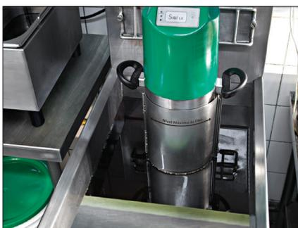
**6** Conecte o cordão de extensão à tomada de 220 V. Uma lâmpada vermelha (LED) permanece piscando no modo de espera (*standby*). Pressione o botão
