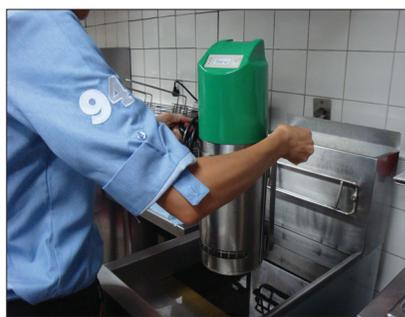
**8** **Limpeza do Sollo® LX:** deixe-o esfriar, abra a porta e descarte o filtro. Limpe a parte inferior do Sollo® LX com água quente. A parte externa deve ser limpa com toalha de papel ou pano úmido. Não use abrasivos nem esponja de limpeza. **ATENÇÃO: Não mergulhe o Sollo® LX em água e nem o coloque em máquina de lavar. Isto vai danificar as partes elétricas e eletrônicas instaladas na parte superior.**
