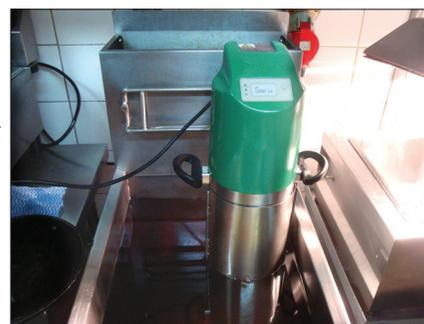
**7** Levante o Sollo® LX e segure por alguns segundos para drenar o óleo retido. Coloque o Sollo® LX numa bandeja ou cuba pequena e leve-o a próxima fritadeira, repetindo os passos a partir do **Passo 4**. Ao final das filtrações coloque o Sollo® LX numa bandeja e desconecte a extensão da tomada. **AVISO: Não ligue o Sollo® LX mais do que 3 vezes em seguida.**
