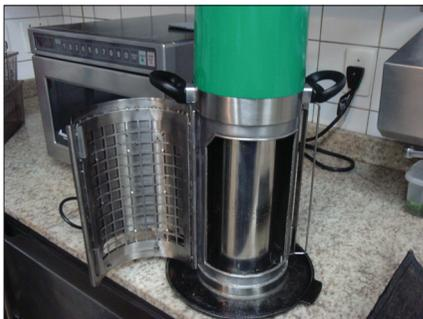
**2** Posicione o filtro com o lado liso sobre a tela encostando nas 2 guias limitadoras.
