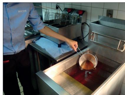
**5** Desligue a fritadeira e coloque o Sollo® LX dentro dela apoiado sobre a tela metálica da cuba. **AVISO: Sollo® LX poderá tombar durante a filtragem se não estiver bem apoiado.**
